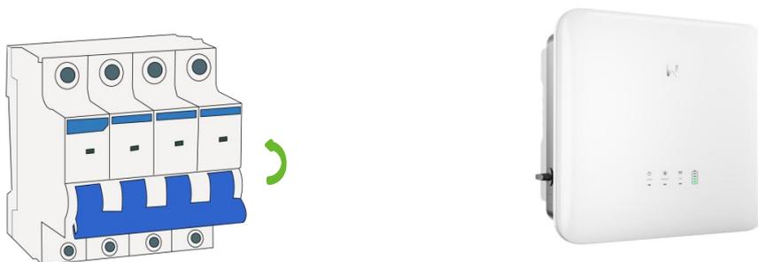
Schalten Sie die Batterie ein: Schalten Sie den Leistungsschalter an der BDU ein, schalten Sie den Netzschalter ein und halten Sie die Taste „Aufwecken“ 5 Sekunden lang gedrückt.
